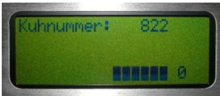
Bild 07: 6 Balken und numerischer Wert 0 bedeuten einen hohen Progesterongehalt der Testmilch
