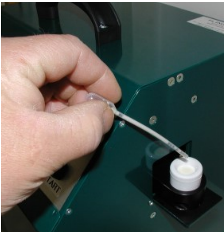
Bild 04: Einfüllen der Milch in den Reagenzbecher
