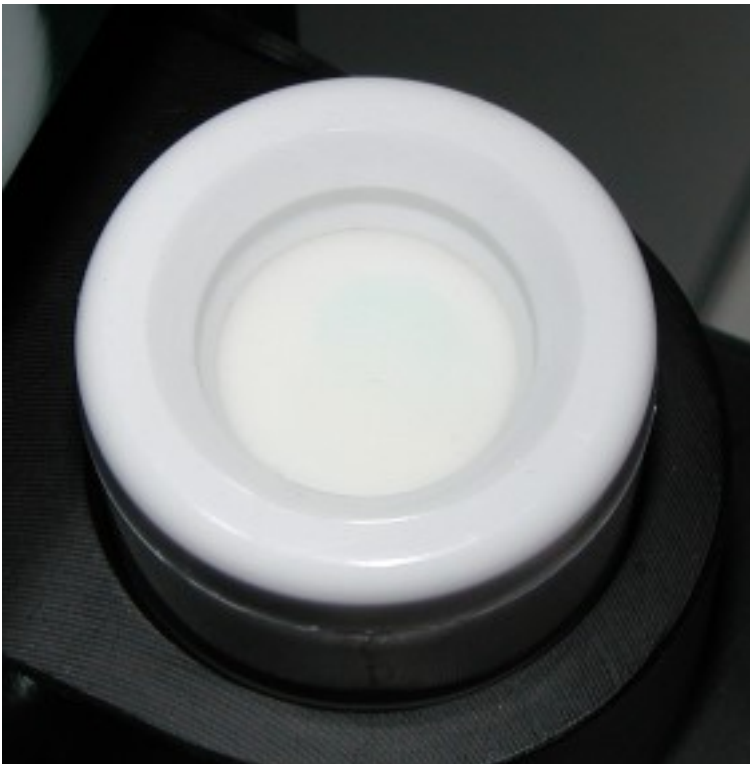
Bild 08: Geringe Blaufärbung bei mittlerem Progesterongehalt
