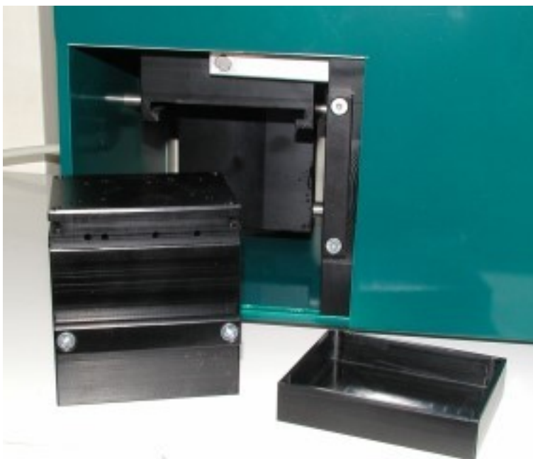
Bild 02: Einsetzen des Behälters zu Testbeginn
